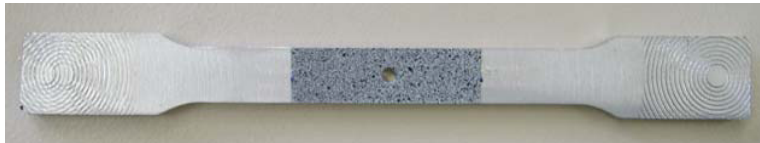
Abb. 22: Versuchsprobe mit stochastischem Muster
