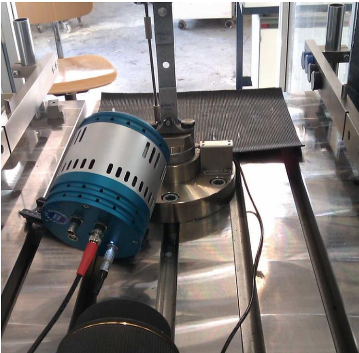
Zugprüfungen, 2D-Optik, quasistatisch, 0.3 m/s, 5 m/s
