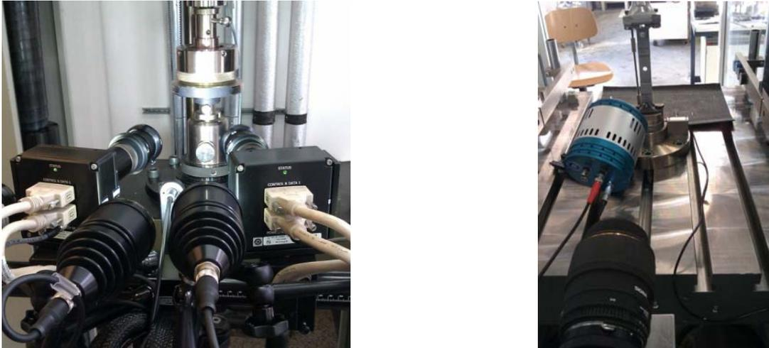
Figure 1: Quasistatischer Druckversuch (links) , Hochgeschwindigkeitszugversuch (rechts)
